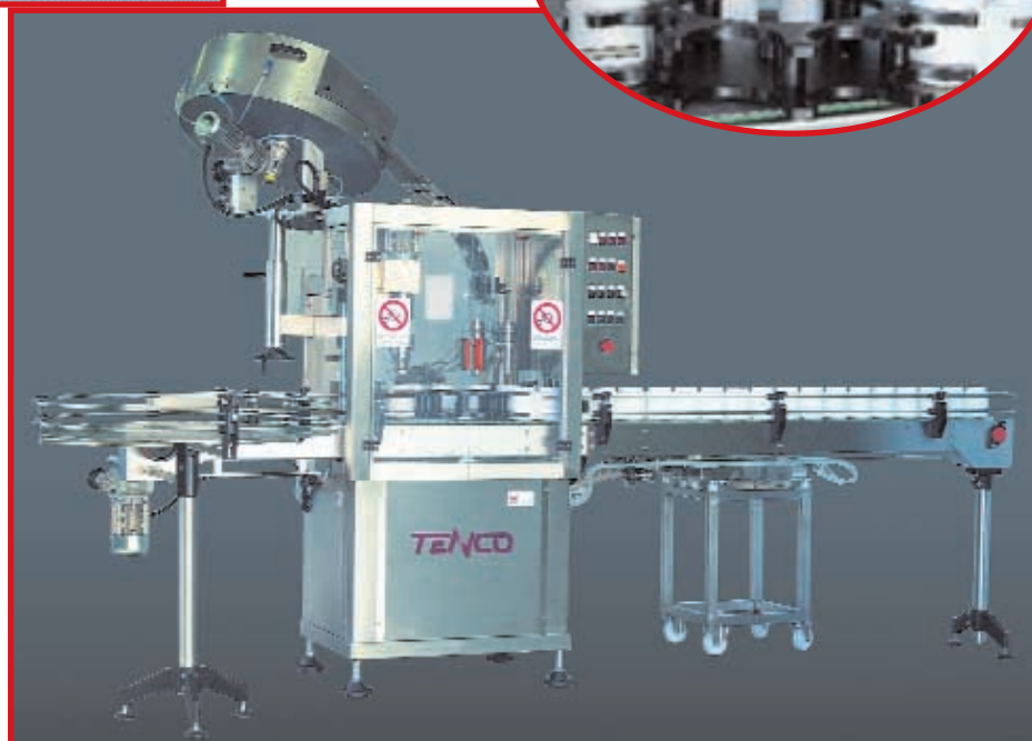
MONOBLOCCO PER RIEMPIMENTO E TAPPATURA FILLING AND CAPPING MONOBLOC MONOBLOC POUR REMPLISSAGE ET CACHETAGE
